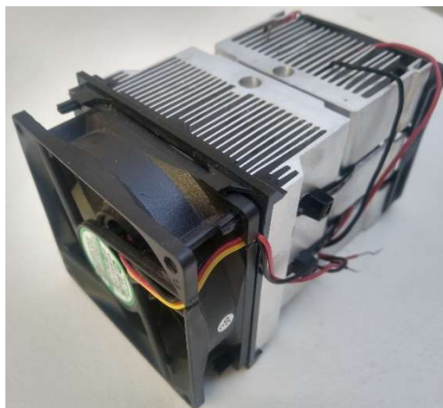
Figura 10 – Dispositivo de aquecimento e resfriamento, pastilha Peltier e dissipador de calor
